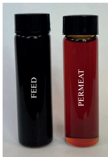
Рис. 8. Фотография исходной нефти и пермеата после фильтрации через мембрану М-2.
