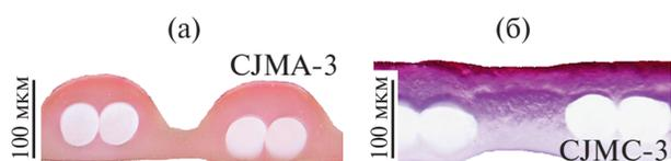
**Рис. 3.** Оптические изображения срезов анионообменной мембраны SJMA-3 (а) и катионообменной мембраны SJMC-3 (б) после их участия в ЭД тартратной стабилизации модельного виноматериала в режиме НЭП. Верхняя сторона мембран была обращена в камеру обессоливания, через которую прокачивался модельный виноматериал.
