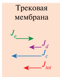
Рис. 5. Схематичное изображение составляющих потоков ионов лития через трековую мембрану при разделении катионов методом ЭБМ.
