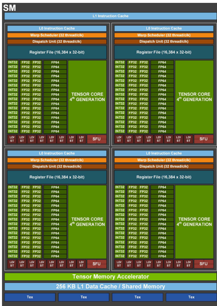
Рисунок 6. Общее построение SM в H100 (рисунок из [78])
