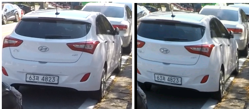
Рисунок 5. Оригинальное изображение до стабилизации и артефакт с наклоном автомобиля при использовании профиля Constant High метода MeshFlow
