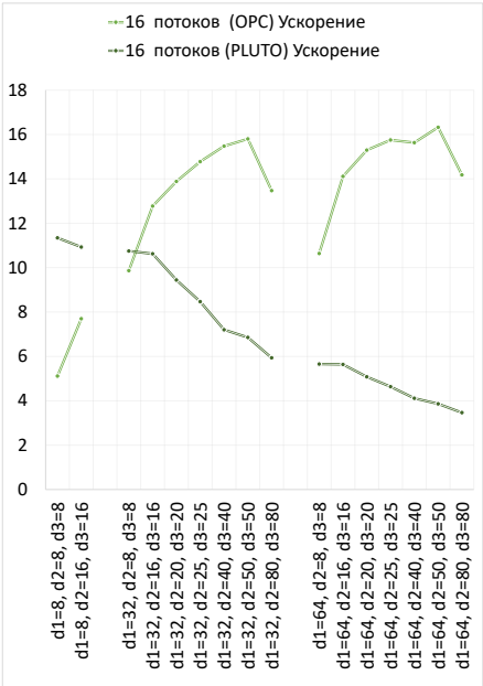
Рисунок 8. Сравнение ускорений при выполнении на 16 потоках, полученных при помощи PLUTO и разработанного алгоритма оптимизации (в OPC) для алгоритма Гаусса-Зейделя.
