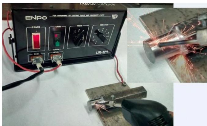
Рис. 3. Электроискровая обработка поверхности хвостовика
