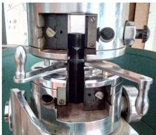
**Рис. 4. Опытный образец перед сообщением крутящего момента**
