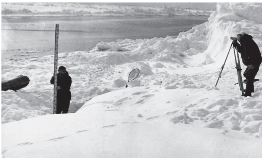
Рис. 3. Измерение морфологических параметров надводной части морских льдов в районе СП-22. Апрель 1974 г. Фото Н. М. Шестакова.
