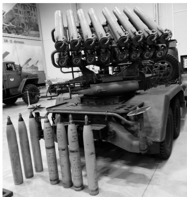
Рис. 5. Трубчатые направляющие БМ-14-17
