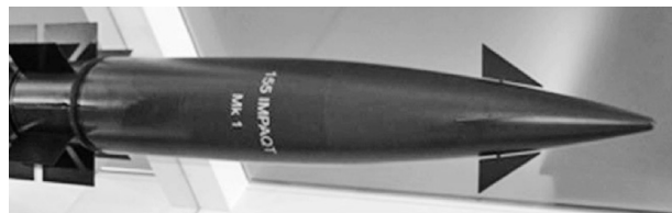
Рис. 5. Модель англо-франко-шведского 155-мм высокоточного снаряда повышенной дальности Impaqt Mk1
