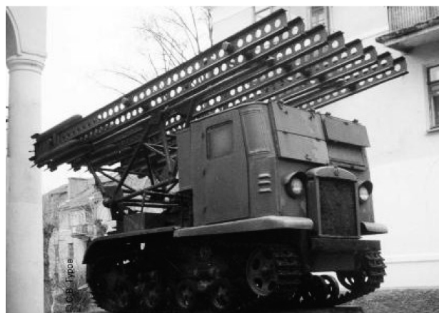
Рис. 2. Пусковая установка М-13 на шасси трактора СТЗ-5
