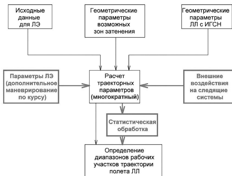
Рис. 1. Структурная схема усовершенствованной математической модели внешних воздействий на следящую ИК-систему
