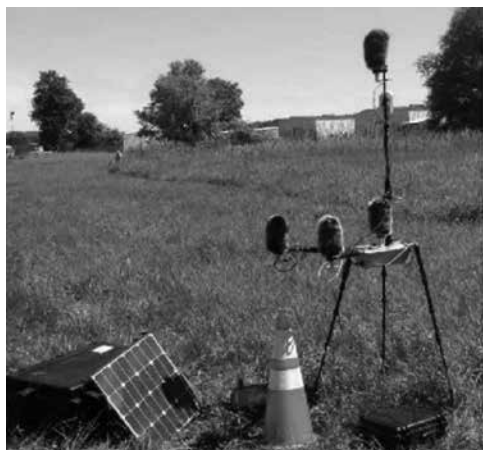
Рис. 5. Микрофонный узел системы акустического обнаружения ТИС, развернутый в полевых условиях (слева). Микрофон (справа)
