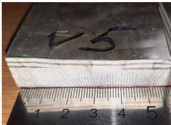
Рис. 4. Макрошлиф композиционного материала
