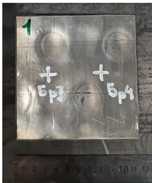
Рис. 11. Внешний вид подготовленного для испытания на пулестойкость экспериментального образца композиционного броневых материала
