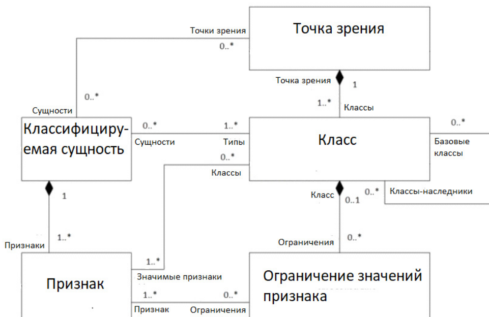
Рис. 1. Метамоделю подхода к классификации, основанного на «точках зрения» (перевод на русский на основе англоязычной модели из работы [14])
