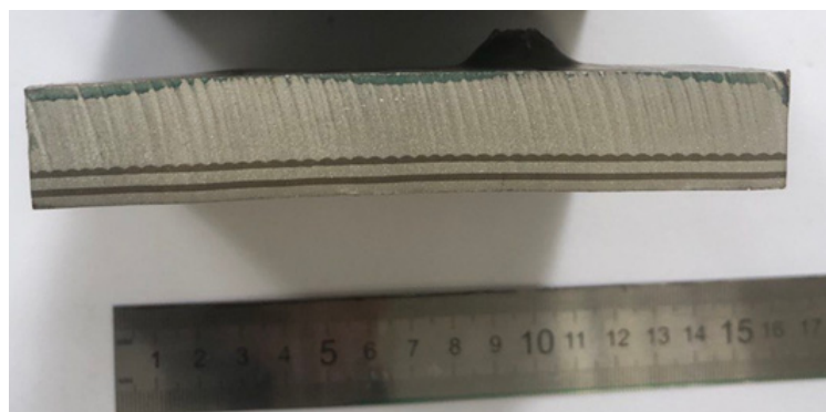
Рис. 13. Результат оценочных испытаний по классу защиты по пулестойкости Бр3 и Бр4 по ГОСТ 34286–2017 (вид сбоку)
