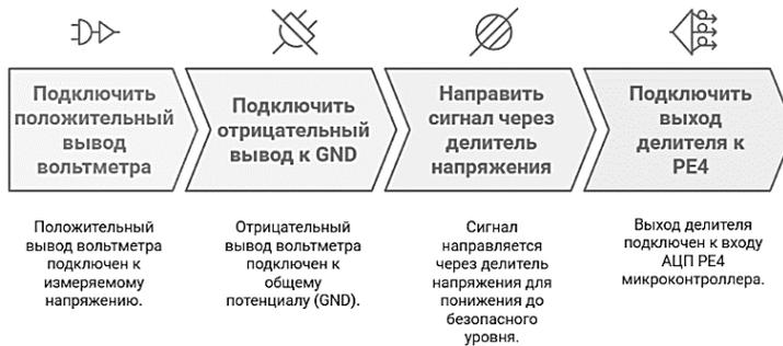
Рис. 4. Алгоритм подключения вольтметра к аналого-цифровому преобразователю микроконтроллера
