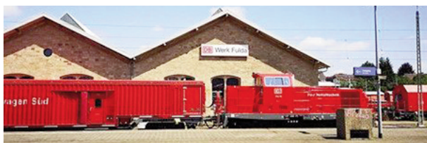
Рис. 1. Локомотив и первый вагон спасательного туннельного поезда (Германия). Контейнерная концепция медицинского вагона [6] Fig. 1. Locomotive and the first car of the rescue tunnel train (Germany). Container concept of a medical wagon [6]
