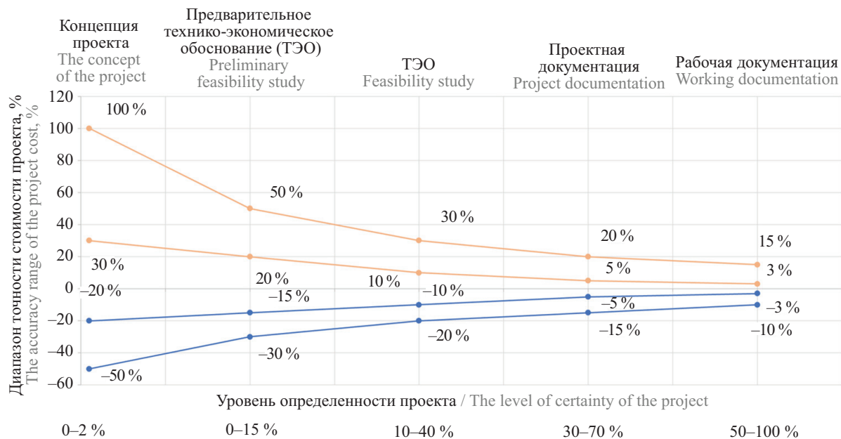
Рис. 2. Существующая точность оценки стоимости строительства на различных этапах жизненного цикла объекта (МАРСИ)
