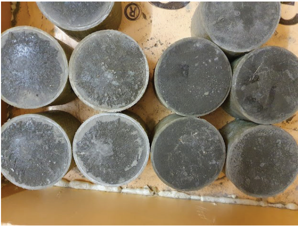
Рис. 7. Образцы, замороженные без утепления (слева) и с утеплением (справа)
