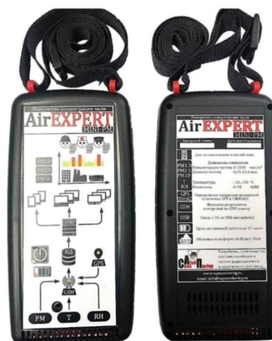
Рис. 2. Мобильный измеритель концентрации пыли AirExpert Mini PM
