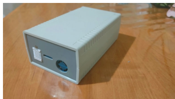
Рис. 3. Измеритель концентрации мелкодисперсных аэрозолей (ПИКМА)
