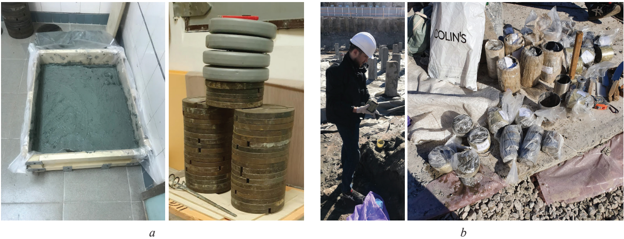
Рис. 2. Создание грунта нарушенной структуры (а); отбор грунта ненарушенной структуры (б)
