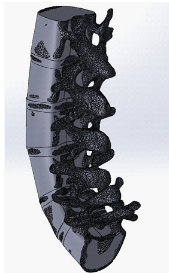
Рис. 2. Процесс построения упрощенной твердотельной модели
