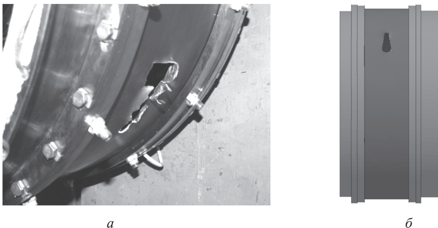
Рис. 5. Результаты эксперимента (а) и расчетов (б) для ОТ4. Толщина стенки корпуса 2 мм
