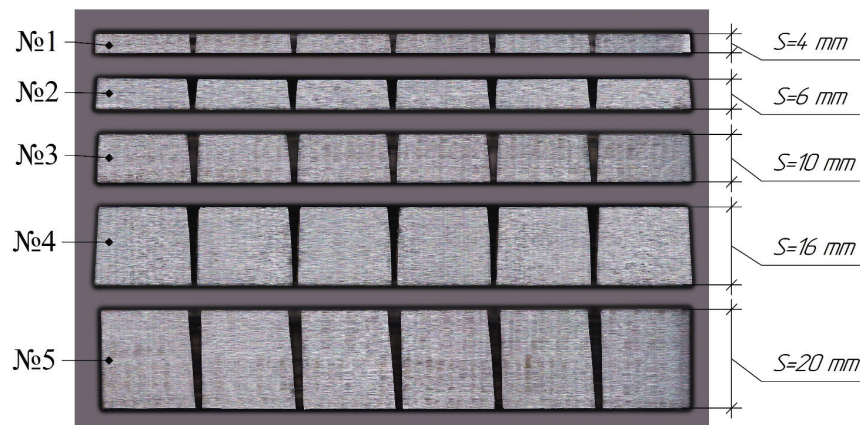
Рис. 2. Фотографическое изображение поперечного сечения образцов различной толщины после раскроя по технологии HiFocus plus
