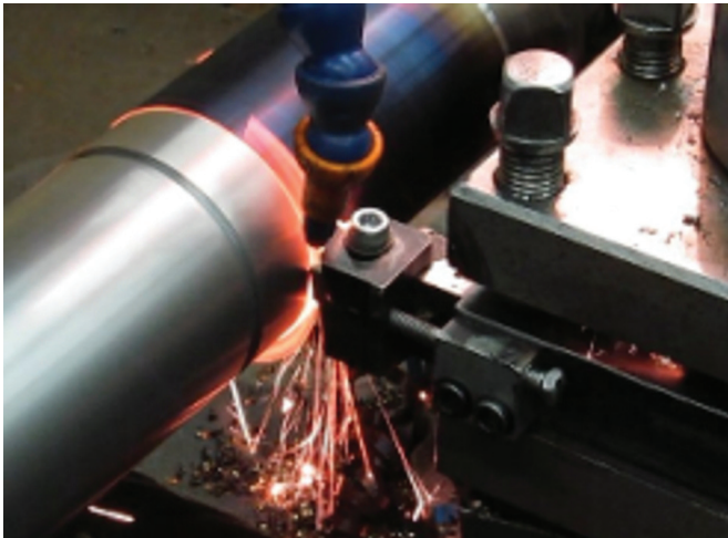
Рис. 2. Фотография процесса закалочного ДР Fig. 2. Photo of DC quenching
