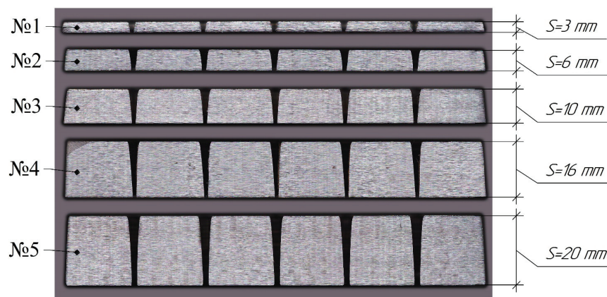
Рис. 3. Фотографическое изображение поперечного сечения образцов различной толщины после раскроя по технологии HiFocus F
