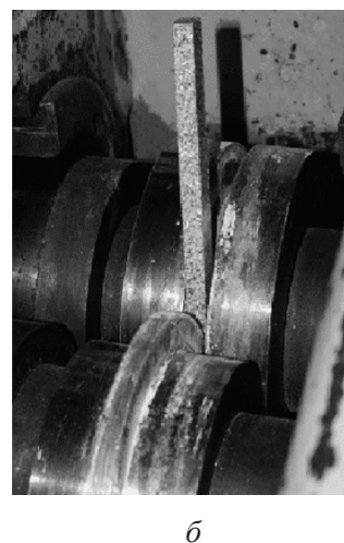
Рис. 1. Схема холодного прессования заготовки из стружки (а) и фото последующей горячей обработки на установке совмещенного процесса прокатки-прессования (б)
