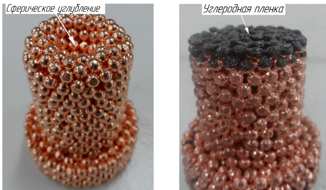
а б Рис. 12. Медный ЭИ, применяемый при КПЭЭО: а – до обработки; б – после обработки [53]
