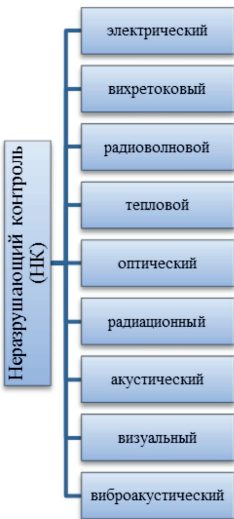
Рис. 1. Виды неразрушающего контроля (НК)
