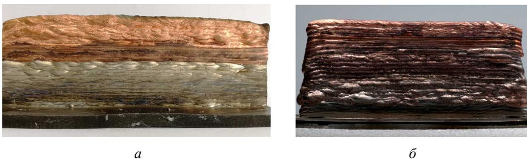
Рис. 14. Внешний вид бездефектных биметаллических образцов с резким (а) и плавным (б) интерфейсом при корректно подобранных параметрах во время изготовления методом ЭЛАП
