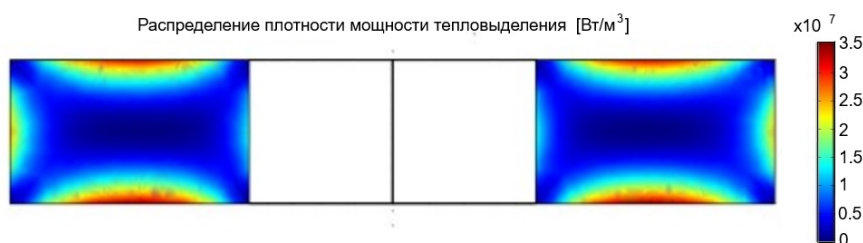
Рис. 3. Распределение плотности мощности тепловыделения в разрезе кольца ( y = 0 )
