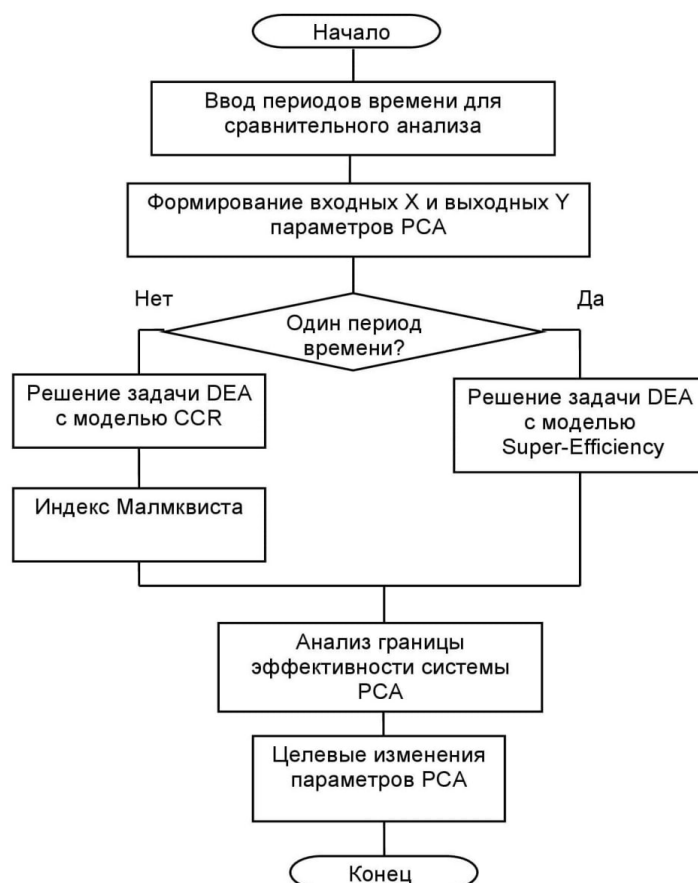
Рис. 1. Алгоритм анализа эффективности виртуальных испытаний
