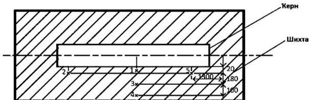
**Рис. 3.** Схема установки термопар в сечении печи в эксперименте
