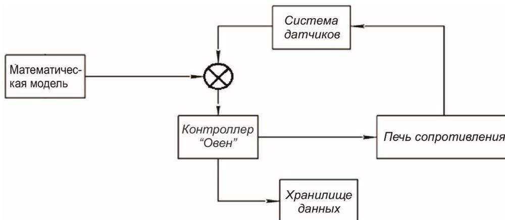
**Рис. 4.** Система автоматизированного управления процессом производства карбида кремния
