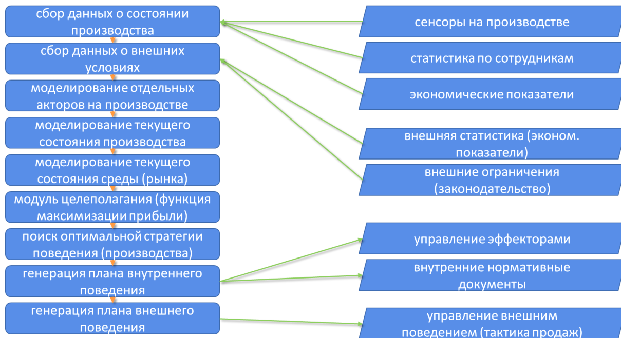
Рис. 3. Схема системы управления процессом производства робототехнических комплексов
