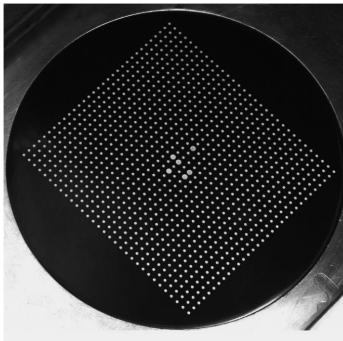
Рис. 4. Полученное камерой изображение паттерна (рис. 3), прожженного на подложке Fig. 4. The image of the pattern (fig. 3), burned on the substrate, obtained by the camera
