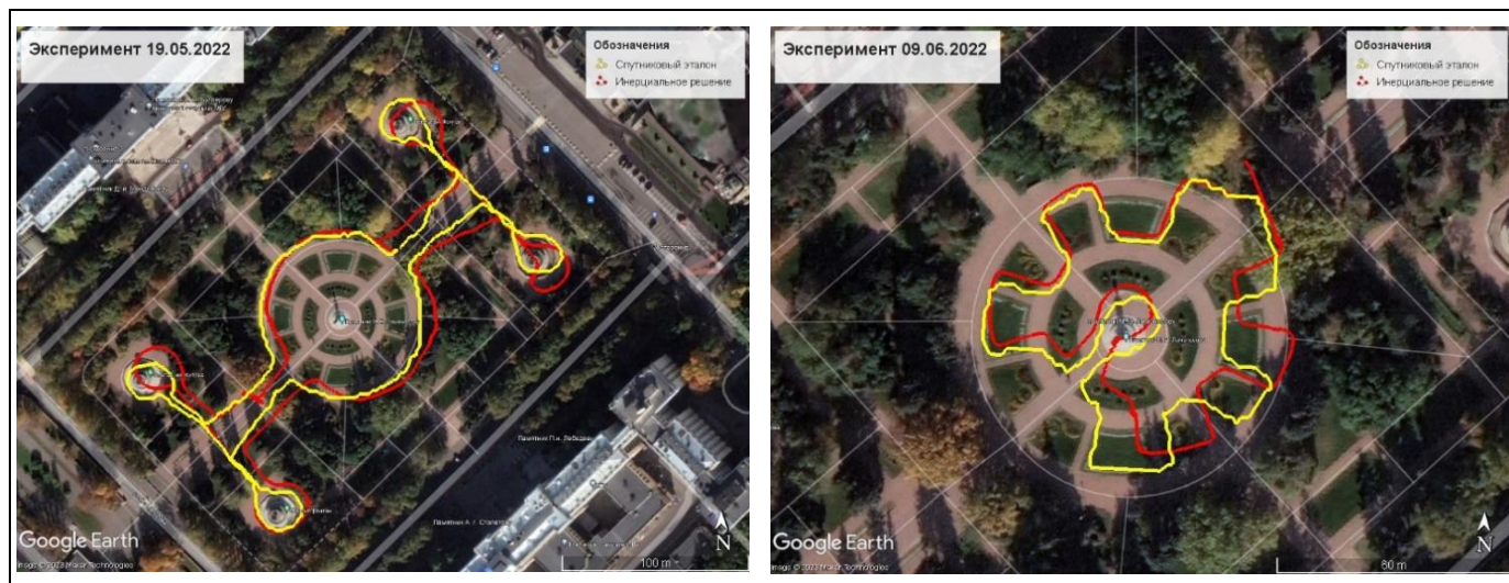
Рис. 6. Спутниковый эталон и инерциальное решение для двух экспериментов
