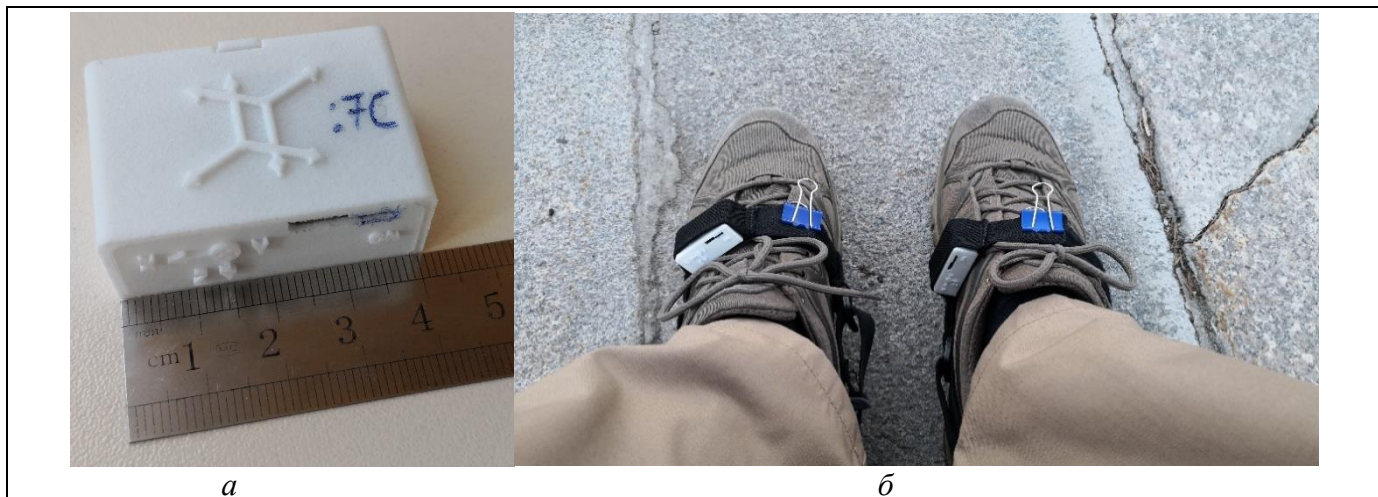
Рис. 4. Внешний вид датчика (а) и способ крепления датчиков на стопах (б)
