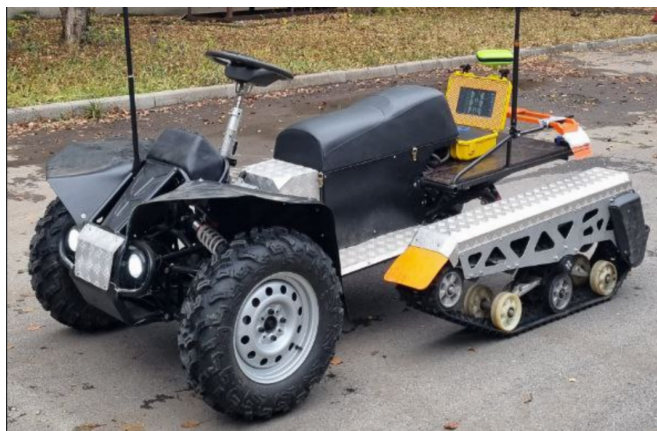
Рис. 1. Колёсно-гусеничная платформа для сбора данных
