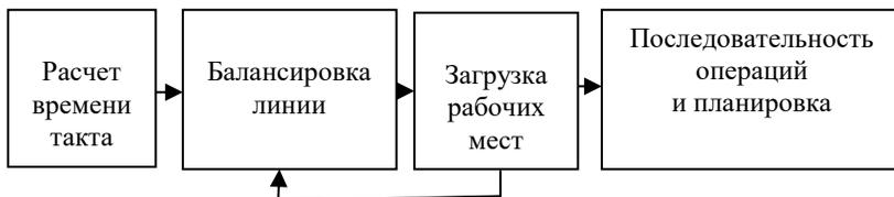
Рис. 1. Алгоритм проведения балансировки поточной линии сборки
