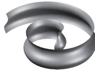
Рис. 11. Резная поверхность Монжа с цилиндрической направляющей поверхностью и меридианом в виде синусоиды [Figure 11. Monge carved surface with cylindrical guide surface and sinusoidal meridian]
