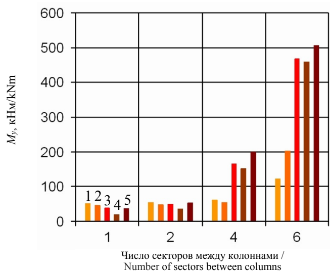
Рис. 11. Максимальные моменты M_y в нижнем кольце купола. Виды сопряжений:
