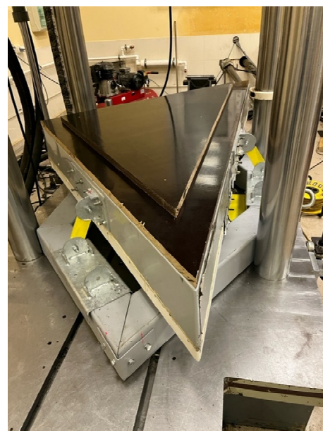
Рис. 7. Установка образца в испытательной машине, С.В. Ключева Источник: фото А.Р. Масёнене
