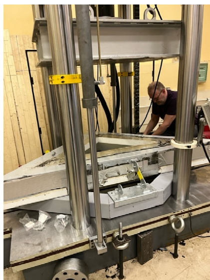
Рис. 4. Расположение образца с оснасткой на опорной плите испытательной машины И с т о ч н и к: фото А.Р. Масёнене, С.В. Ключева Figure 4. Position of the sample with equipment on the base plate of the testing machine S o u r c e: photo by A.R. Masenene, S.V. Klyuev
