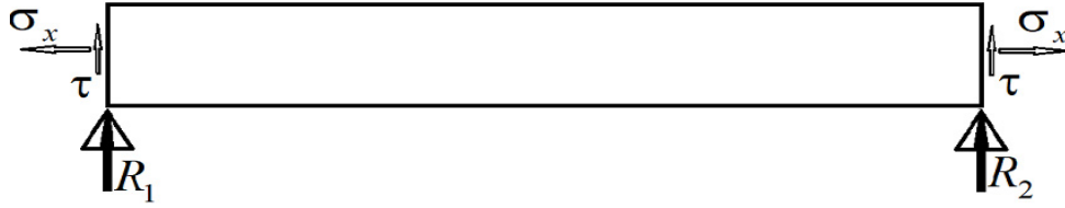
Рис. 2. Напряжения на коротких сторонах полосы, которые должны быть обращены в ноль при свободном опирании
