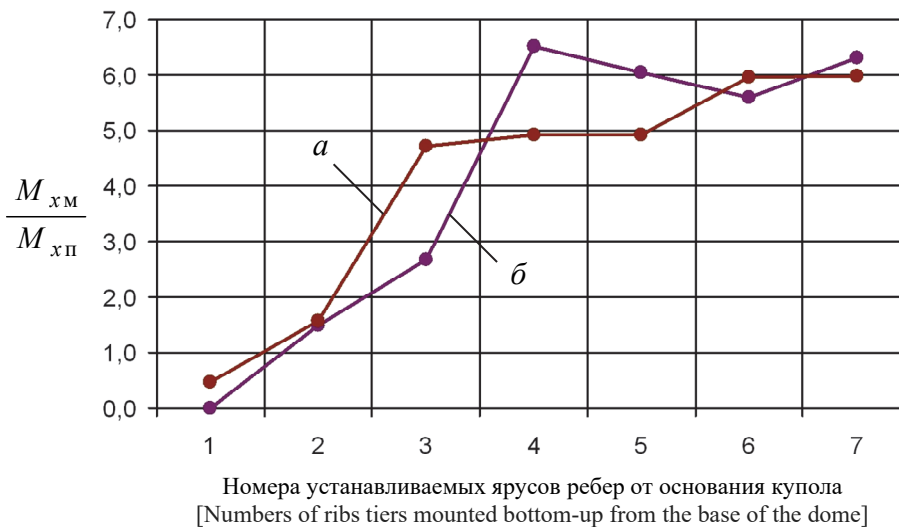
Рис. 5. Отношение M_{хм,i}/M_{хп,i} в поярусных элементах ребер при установке консольных ребер:
