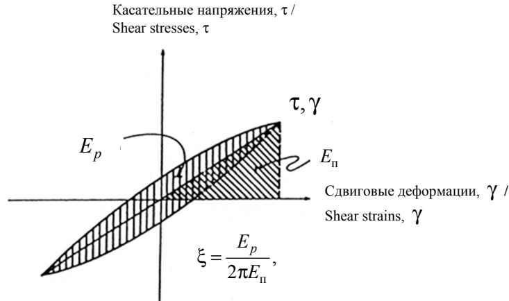
Рис. 5. Схема для определения демпфирования (петля гистерезиса)
