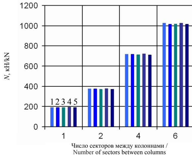
Рис. 12. Максимальные усилия N в колоннах под куполом. Виды сопряжений:
