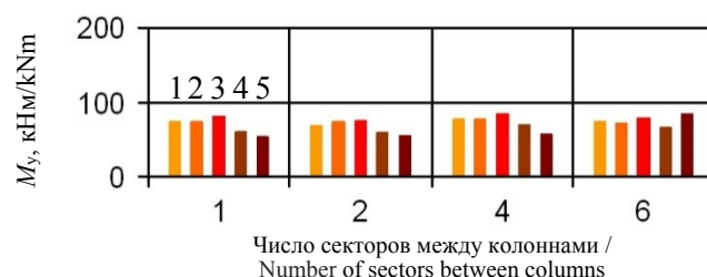
Рис. 8. Максимальные моменты M_y в меридиональных ребрах купола. Виды сопряжений:
