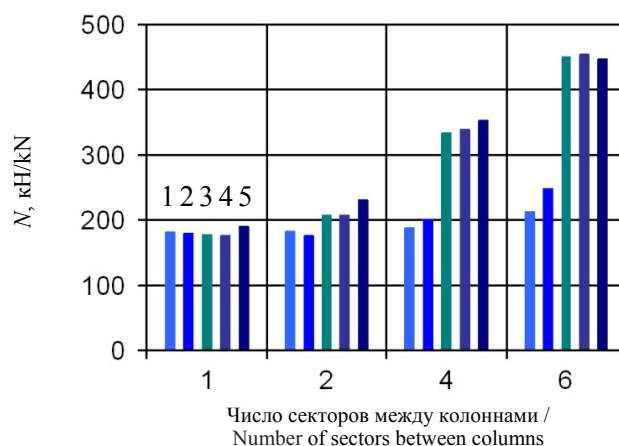
Рис. 6. Максимальные усилия N в меридиональных ребрах купола. Виды сопряжений: 1 — ШЗ; 2 — Ш2; 3 — Ш1; 4 — Ж1; 5 — Ж2
