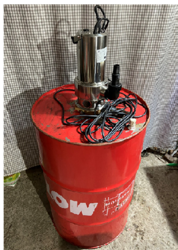
Рис. 4. Вакуумный анкер из бывшей в употреблении металлической бочки:
