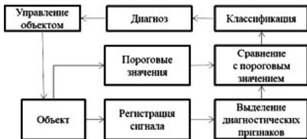
Рис. 1. Функциональная схема управления состоянием объекта
