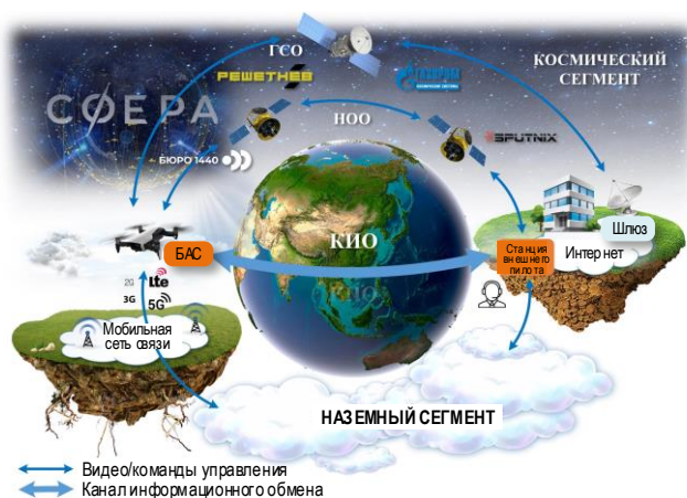
Рис. 2. Структура ГОНСС для FPV-управления БВС
