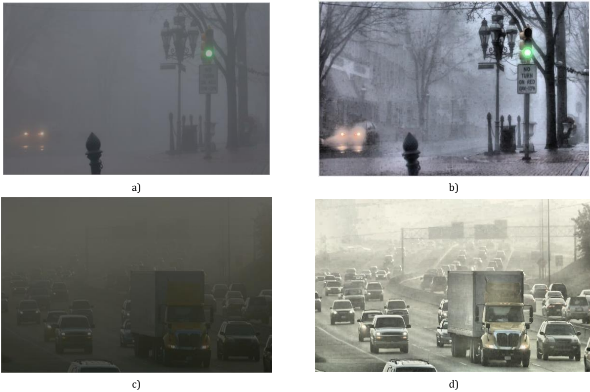
Рис. 4. Результат обработки изображения: оригинальное (а, с) и обработанное гибридным алгоритмом (b, d) Fig. 4. Processing Result: Original Image (a, c) and Image Processed with the Hybrid Algorithm (b, d)
