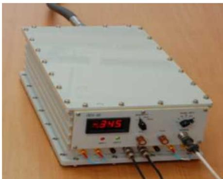
Рис. 1. Одноканальный интерферометр трехмиллиметрового диапазона РИ-03
