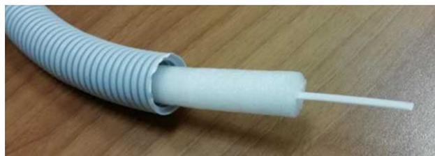
Рис. 3. Внешний вид диэлектрического волновода
