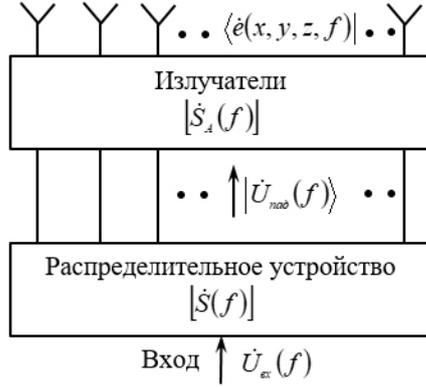
Рис. 11. Матричная модель широкополосной антенной решетки
