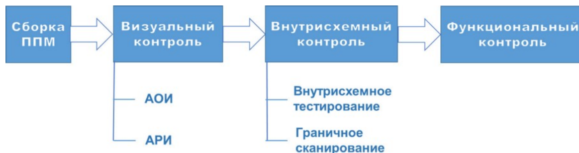
Рис. 2. Методы контроля составных частей РТК в процессе производства
