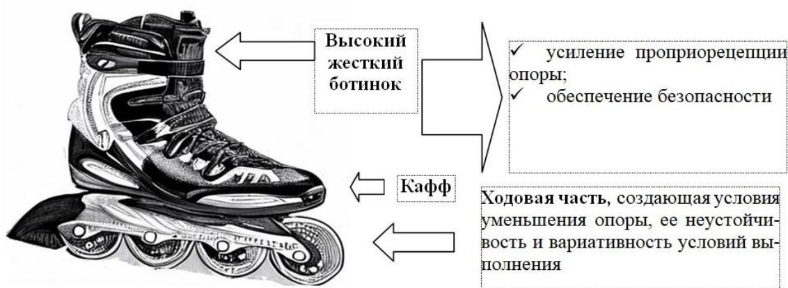
Рис. 4. Строение роликового конька Fig. 4. The structure of a roller skate
