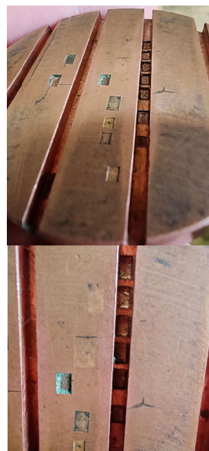
Рис. 1. Образцы с «искусственной шероховатостью», нанесенной лазерным методом
