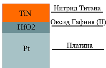
Рис. 2. Структура используемого мемристора
