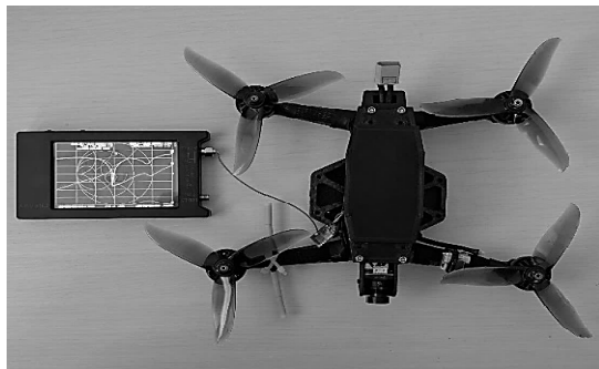
Рис. 1. Процесс измерения электродинамических параметров АФУ
