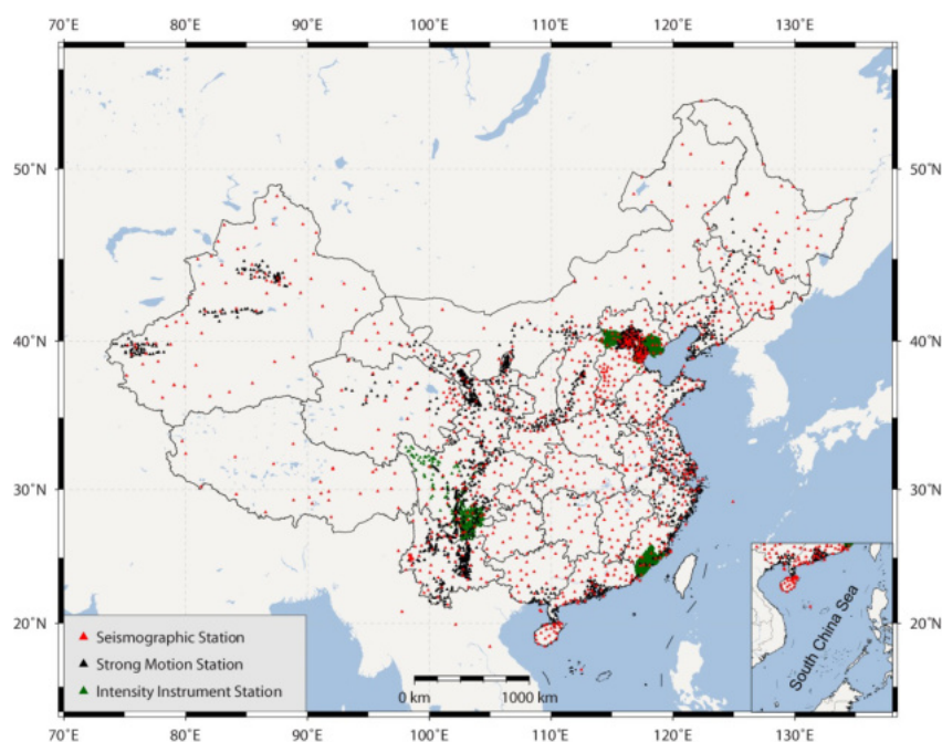
Рис. 4. Расположение станций сети CSN [Dai and An, 2020]. Красным обозначены сейсмографические станции, черным — станции сильных движений, зеленым — станции инженерно-сейсмометрической сети.
