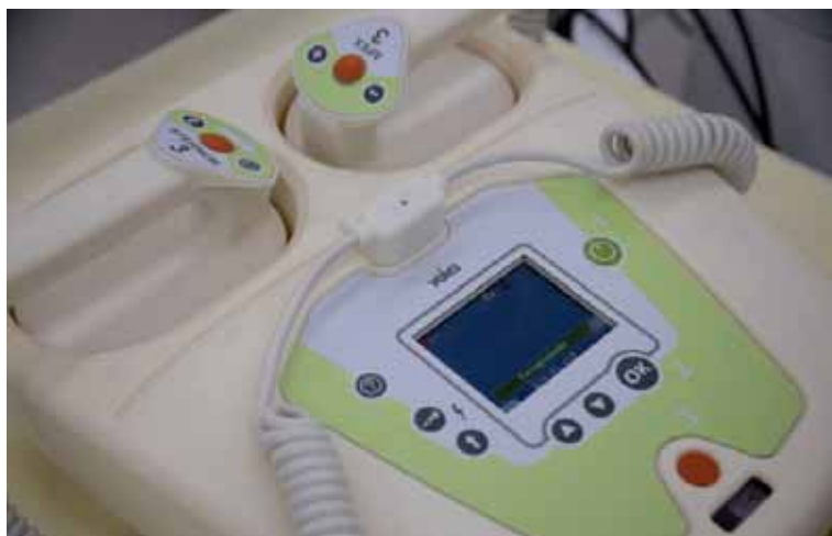
Рис. 3. Автоматический наружный дефибриллятор со встроенной системой диагностики состояния человека.
