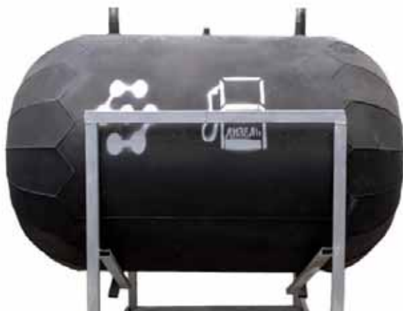
Рис. 5. Реактор получения биотоплива, диаметр 950 мм, длина 1500 мм
