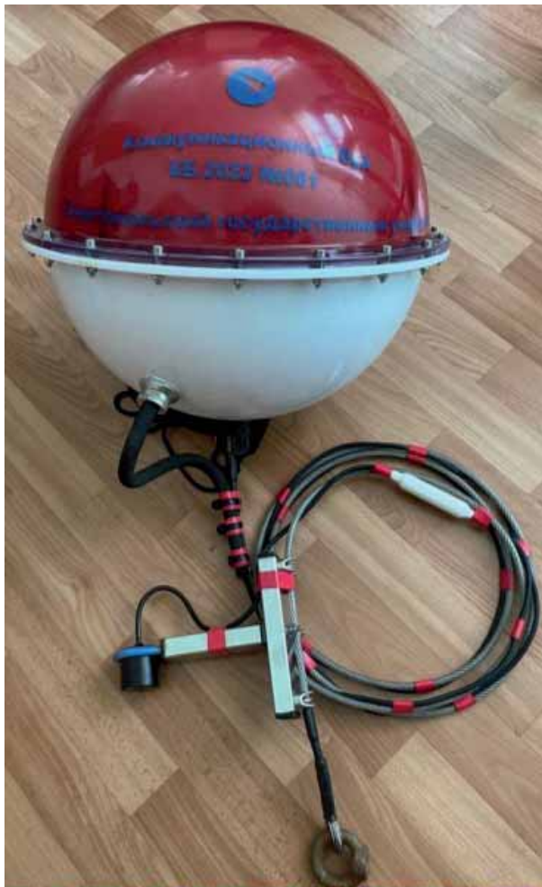
Рис. 5. Морской коммуникационный буй с комбинированными средствами подводной и надводной связи.
