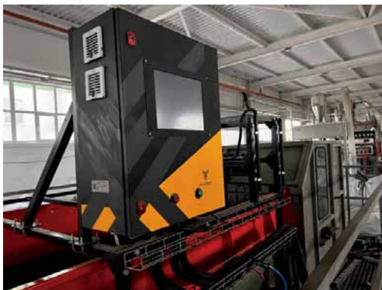
Рис. 2. Внешний вид сепаратора WINGSBEE, установленного на технологической линии мусоросортировочного комплекса.
