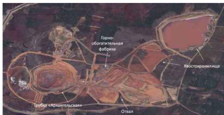
Рис. 3. Схема расположения хвостохранилища месторождения алмазов имени М.В. Ломоносова (вид со спутника).
