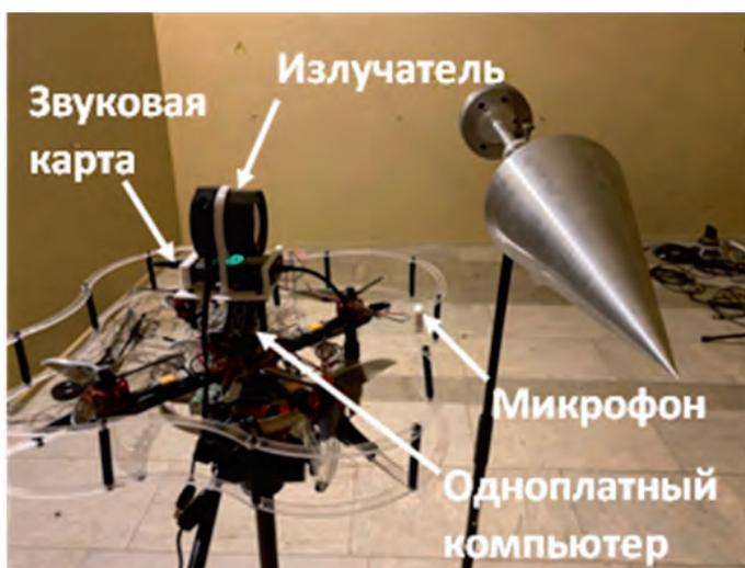
Рис. 2. Пример дифракционного эксперимента с прототипом летательного аппарата.
