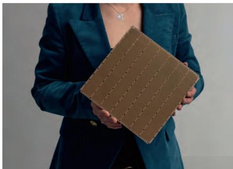
Рис. 1. Вычислитель Wafer-Scale Engine 2 M.
