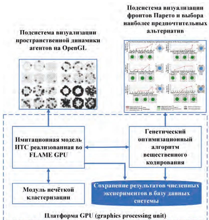
Рис. 2. Укрупненная архитектура программного комплекса, разработанного для ИТС.
