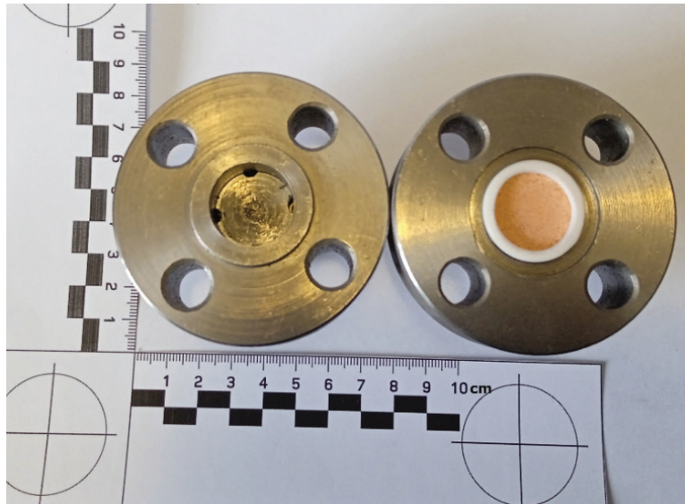
Рис. 1. а – Схематическая диаграмма мембранного модуля: 1 – подача газовой смеси; 2 – вход для установки термометра исходной газовой смеси; 3 – выход газа; 4, 5 – фланцы мембранного модуля; 6 – вход продувочного газа; 7 – вход для установки термометра продувочного газа; 8 – выход продувочного газа; 9 – мембрана; 10 – прокладка; б – фотография мембранного модуля.
